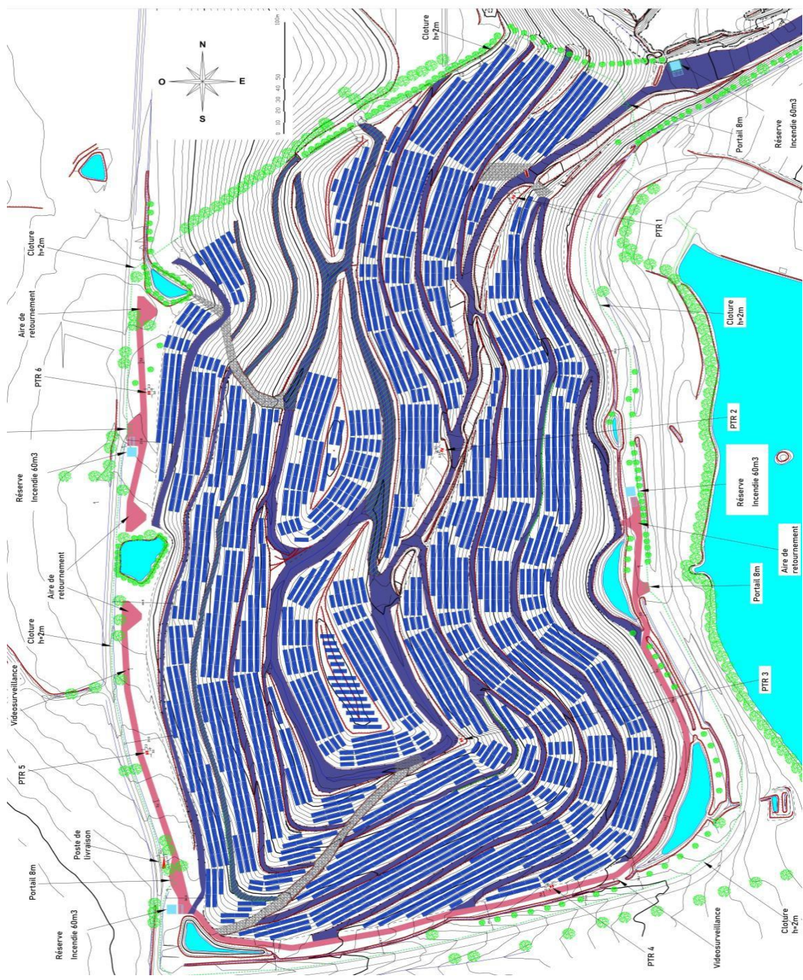
Plan de masse - Implantation des panneaux photovoltaïques
